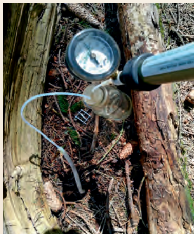
Odběr půdní vody pomocí vakuové pumpy
